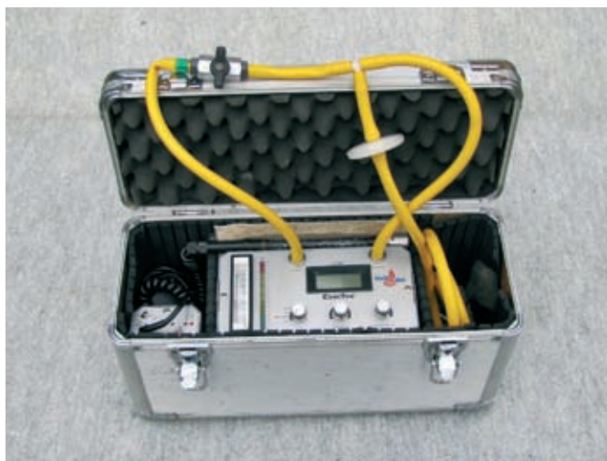
3. Elektroniczne urządzenie typu ComTec do sprawdzania stopnia wycieku gazu z instalacji
