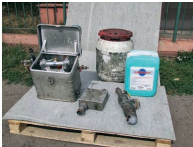
4. Zestaw naprawczy: pompa do wprowadzenia do instalacji emulsji polimeryzującej Garosan, suszarka WaCuTec, wychwytycz gąbek, polimer Garosan oraz beczka do odzysku polimeru
