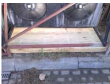
Rys. 7. Taca z drewna do odbioru roztworu ściekającego po powierzchni lameli
