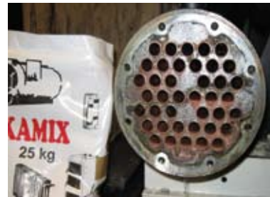
Rys. 17. Stan rurek po 6-godzinnym czyszczeniu 10% roztworem preparatu KAMIX
