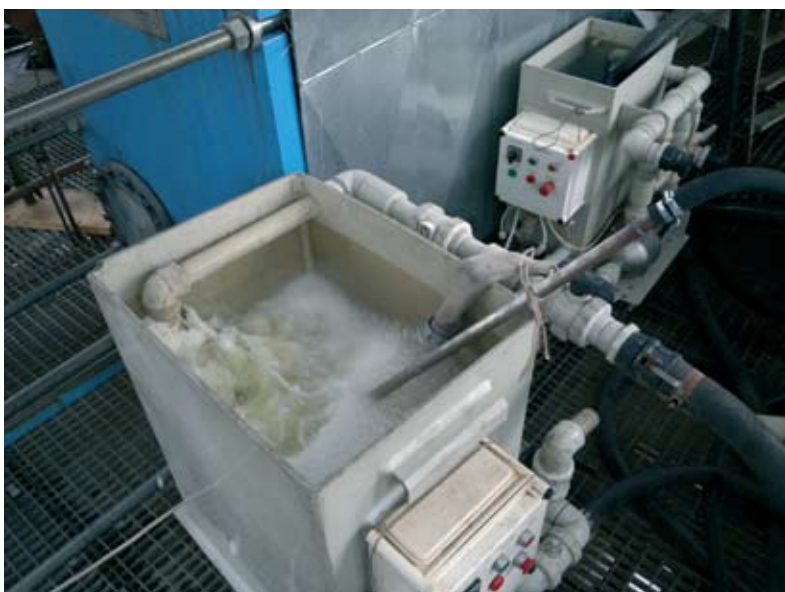
Rys. 11. Przebieg reakcji chemicznej w roztworze preparatu Kamix z jednoczesnym barbotażem parą
