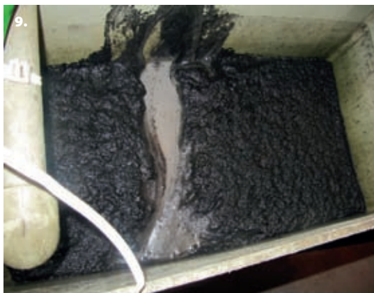
9. Przebieg typowej reakcji chemicznej – roztworzony magnezyt zabarwia roztwór na czarno
